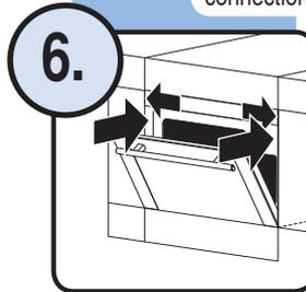
**6. Gerät ganz einschieben, ausrichten**
